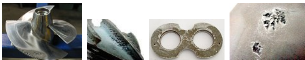
Obr. 10 Příklady kavitačního opotřebení
