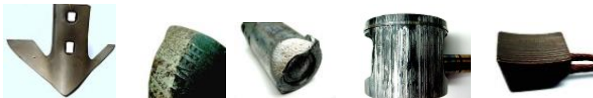
Obr. 7 Příkladů abrazivně opotřebených součástí
