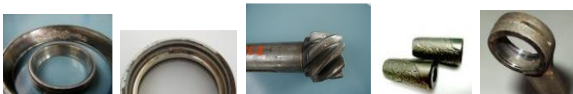
Obr. 9 Příklady opotřebení povrchovou únavou materiálu
