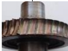
Obr. 3 Příklad adhezivně opotřebené součásti, zadírání
