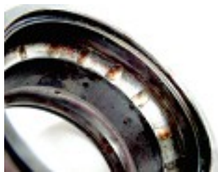
Obr. 6 Příklad vibračně opotřebené součásti, s přístupem vzduchu
