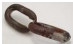
Obr. 4 Příklad velmi pokročilého adhezivního opotřebení
