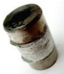
Obr. 3 Příklad adhezivně opotřebené součásti, zadírání
