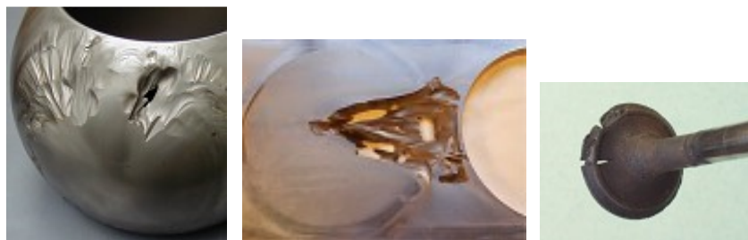
Obr. 8 Příkladů erozivně opotřebených součástí
