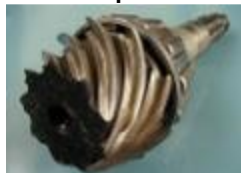
Obr. 4 Příklad velmi pokročilého adhezivního opotřebení
