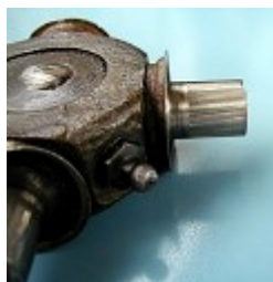
Obr. 5 Příklad vibračně opotřebené součásti, bez přístupu vzduchu
