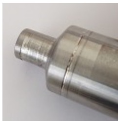
Obr. 2 Příklad adhezivně opotřebené součásti, mírný průběh opotřebení
