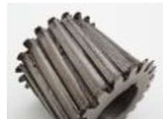
Obr. 3 Příklad adhezivně opotřebené součásti, zadírání
