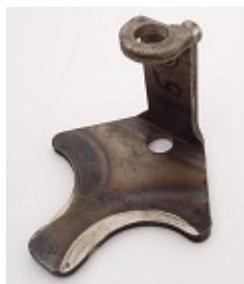
Obr. 1 Příklad adhezivně opotřebené součásti, mírný průběh opotřebení
