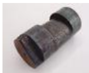
Obr. 4 Příklad velmi pokročilého adhezivního opotřebení
